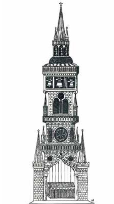
1. Niet te lokaliseren toren. Tekening, 16de eeuw. Bijzonder is het klavier met acht toetsen (stokken) en acht draden naar negen klokken. De overeenkomst met de 19de-eeuwse Amerikaanse chimestands is opvallend (zie verder in dit artikel en afb. 10). Paris, Bibliothèque Nationale, ms. 9152, fol. 188r.
